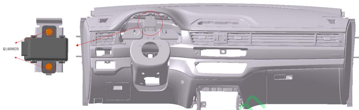
图 1.1 胎压监测主机总成安装位置
